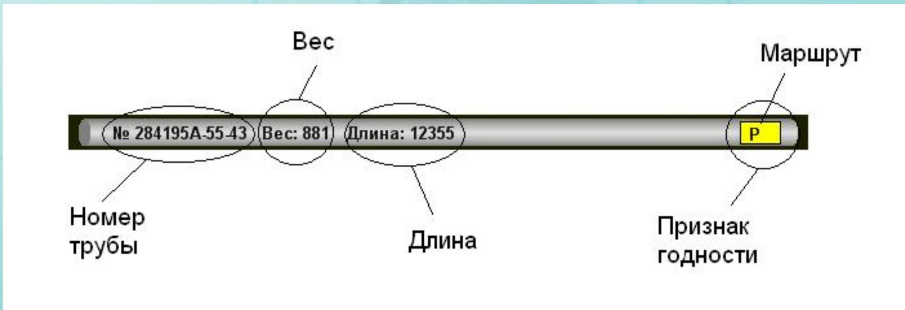
При дальнейшем перемещении трубы по участку к ней привязываются результаты контролей и технологических операций, в зависимости от которых система определяет маршрут трубы и осуществляет перемещение автоматически.
