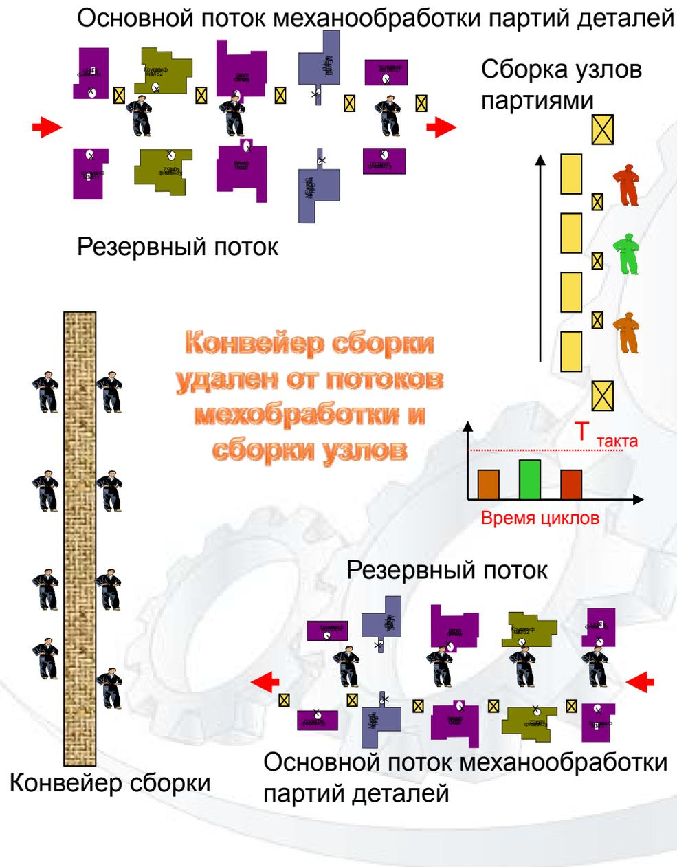
Процессы механообработки и сборки стандартизированы и построены по принципу «Единого потока» и максимально приближены к конвейеру сборки, исключены резервные потоки
